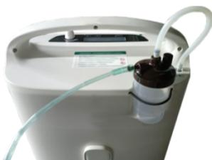
5. Presione el **interruptor de alimentación** en la posición de Encendido (I). El concentrador de oxígeno estará en estado de funcionamiento cuando el indicador de alimentación se ilumine en verde.
