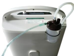
5. Prima o Interruptor de alimentação para a posição Ligado (I). O concentrador de oxigénio está em estado de funcionamento quando o indicador de energia fica verde.
