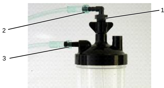
Fig. 19: Installatie van de luchtbevochtiger
